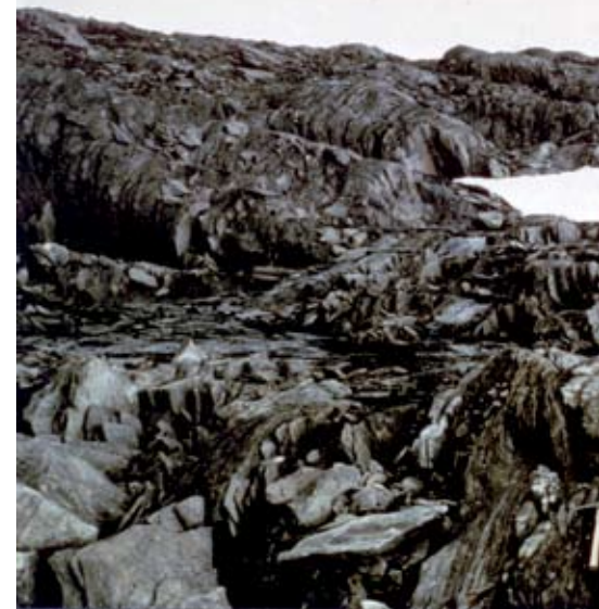
Figur 2 Bergmasse med høy oppsprekkingsgrad og steiltstående anisotropi og dårlig sprengbarhet. Bilde fra Svartisen ved Holmvatn.
