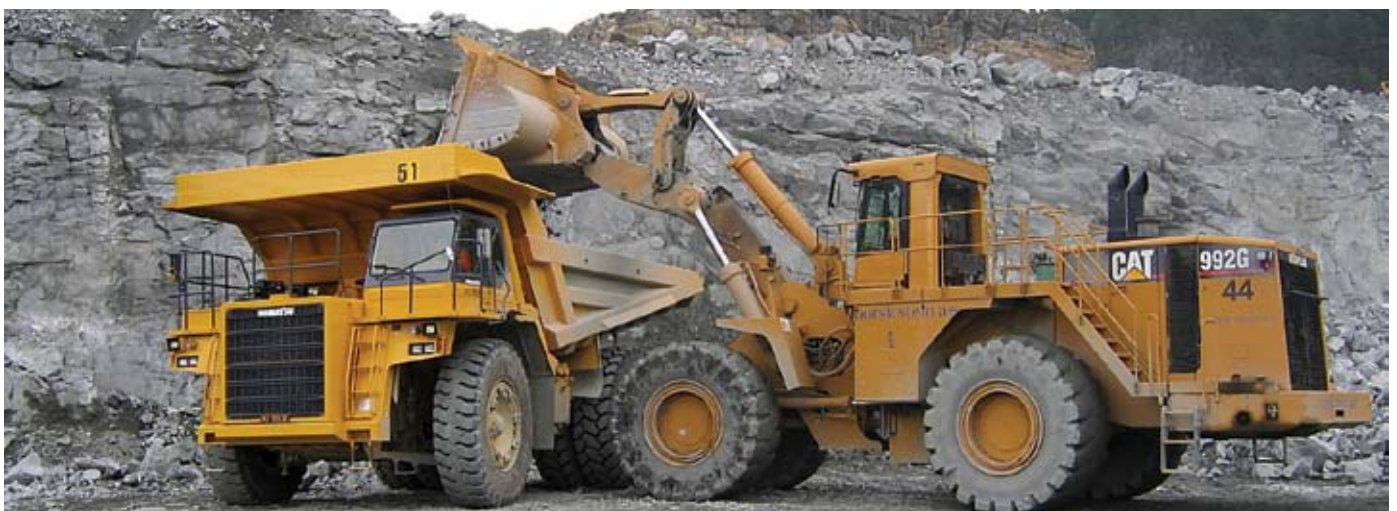
Solide muskler må til i Norges største steinbrudd. Hjulasteren er en Caterpillar 992G og dumperen en Komatsu 785. Foto: Paul Ivar Hov, Norsk Stein AS.
