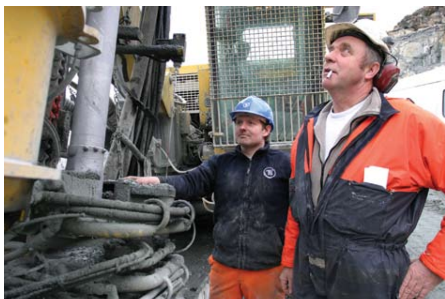
Norsk Stein har landets eneste rigg med senkborhammer, en Atlas Copco L8 som borer 6 1/2" hull og til daglig kontrolleres av Rune Skretting fra T. Stangeland Maskin.
