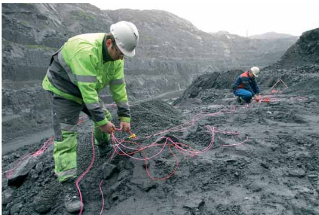
Skytebasene Ingolf Johansen (t.v.) og Frode Reed gjør klar til dagens salve. Hver gang det går en salve, må de rapportere til jordskjelvsenteret i Bergen. Eksplosjonene kan iblant høres helt til Moi, 15 kilometer unna.
