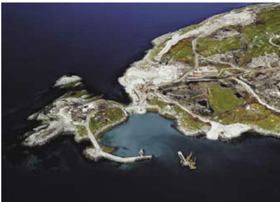
Ca 2,5 millioner kubikkmeter fjell skulle sprenges ut og arbeidet har pågått et knapt år
