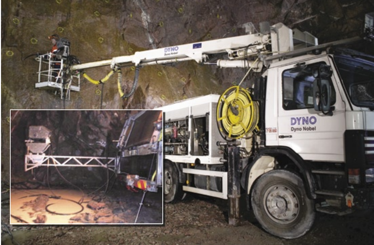
Fig. 1 TITAN SSE truck typ IIB med en extra slangdragare för linje 1 och nytt datasystem
