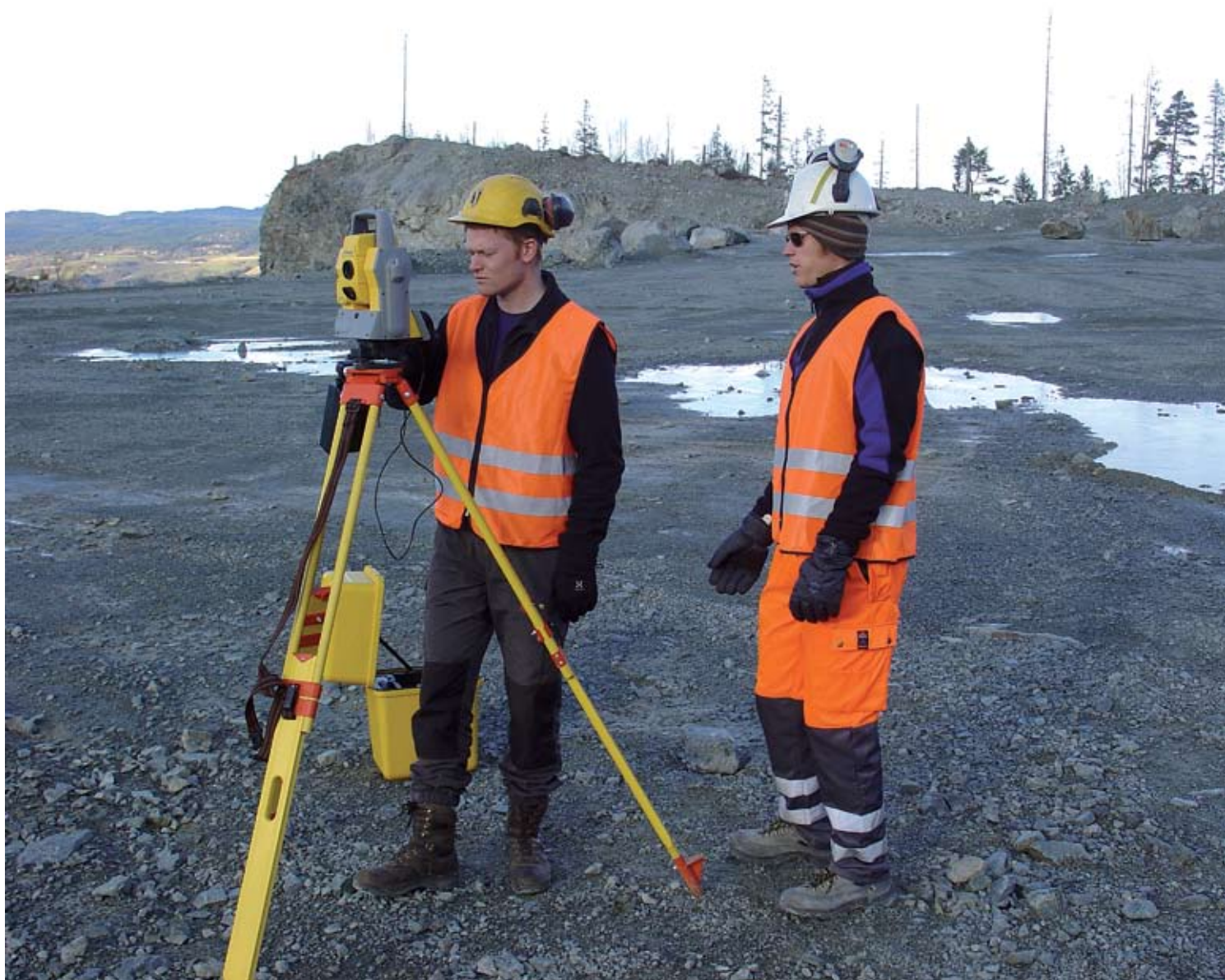
Logging av borhullsavvik og innmåling av borhullskoordinater kan gi redusert sannsynlighet for påboring.
