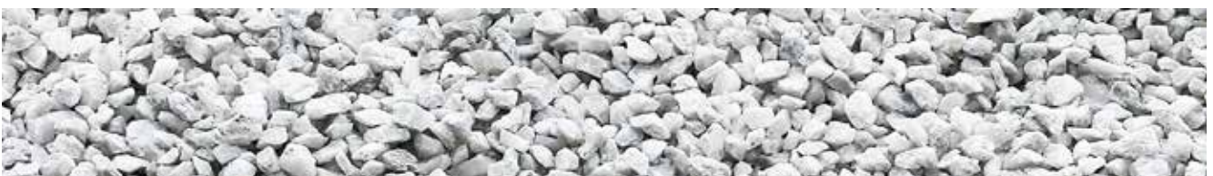
Røys etter salve med 17.5 \text{ m}^2 bormønster. En grovere røys og mindre fremkast
