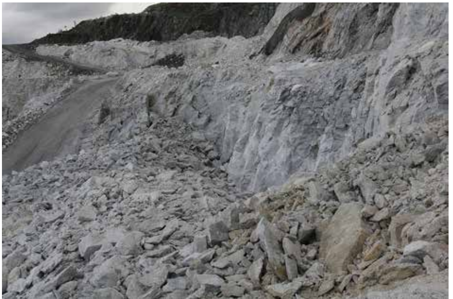
Røys etter salve med 17.5 \text{ m}^2 bormønster. En grovere røys og mindre fremkast
