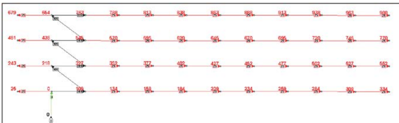
Typisk tennsystem for en kalksalve
