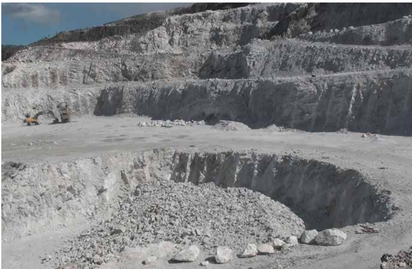
Røys etter prøvesalve med 15.75 m 2 bormønster.
