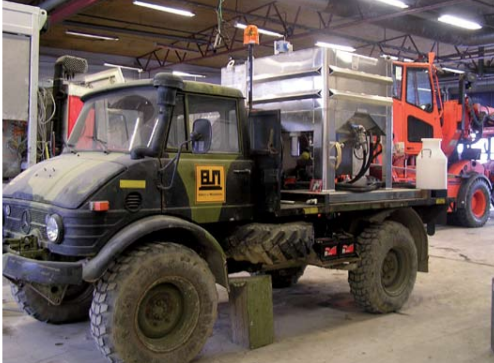
MiniSSE monterad på BEMO-chassi
